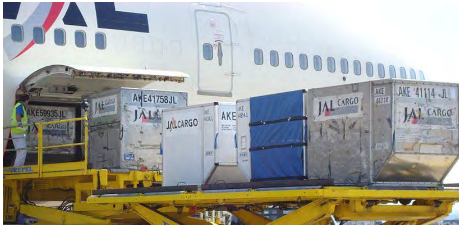
Рис.2 ULD-код на авіаційних контейнерах
