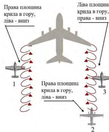
Рис.2. Вплив кінцевих вихорів важкого транспортного літака на поведінку літаків в сліді.
