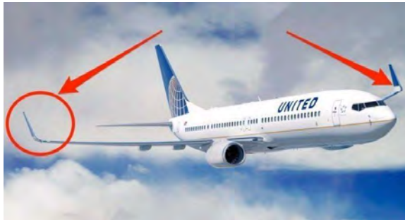
Рис.1. Вінглет сучасного повітряного судна
