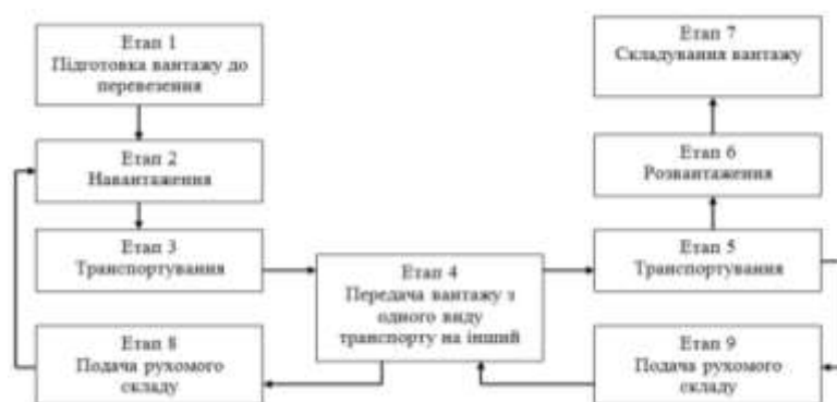
Рис. 1. Технологічна схема доставки вантажів декількома видами транспорту [3, с.8]
